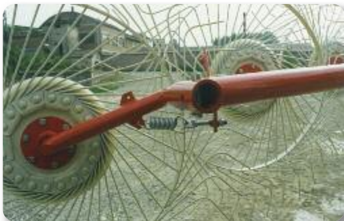
Speciale braccetto oscillante per ranghinatore portato a 5 stelle Special oscillating arm for AM5R-330 3PT
